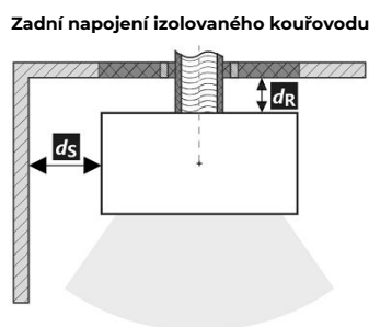
Prostup kouřovodu stěnou z hořlavé hmoty ČSN 06 1008
