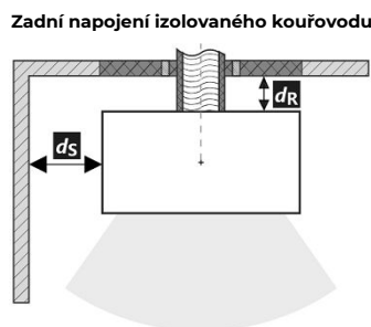
Prostup kouřovodu stěnou z hořlavé hmoty ČSN 06 1008
