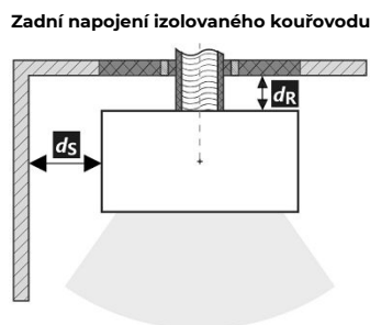
Prostup kouřovodu stěnou z hořlavé hmoty ČSN 06 1008
