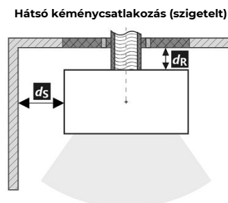
A füstcső áthaladása éghető anyagból készült falon
