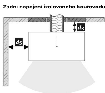
Prostup kouřovodu stěnou z hořlavé hmoty ČSN 06 1008
