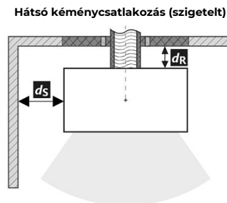
A füstcső áthaladása éghető anyagból készült falon
