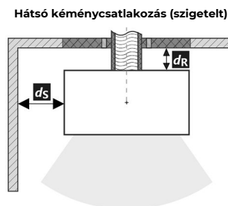
A füstcső áthaladása éghető anyagból készült falon
