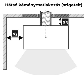
A füstcső áthaladása éghető anyagból készült falon
