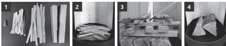
Obr. 4 Postup přípravy dřeva ve spalovací komoře
