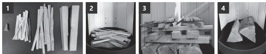
Obr. 4 Postup prípravy dreva v spaľovacej komore
